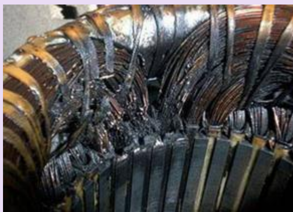
в) обрыв одной фазы обмотки статора
