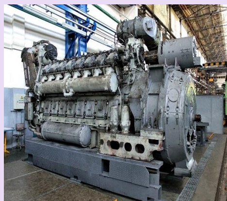
Рис. 5 Дизель после ремонта
