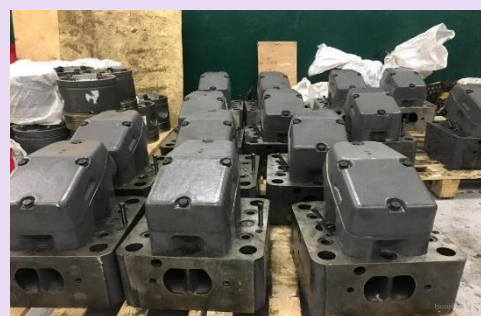
Рис. 7 Крышки цилиндров после ремонта
