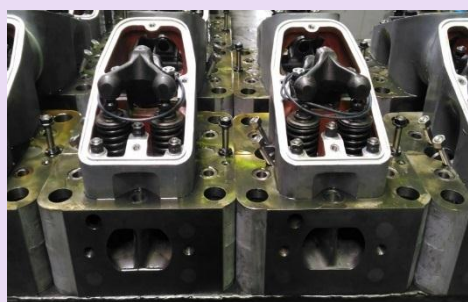
Рис. 6 Крышки цилиндров на ремонте
