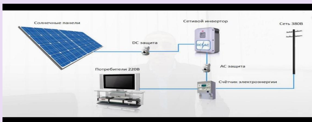
Рис.3 Схема работы солнечной электростанции
