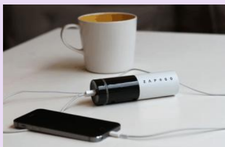
Рис. 4. Зарядное устройство на графеновом суперконденсаторе
